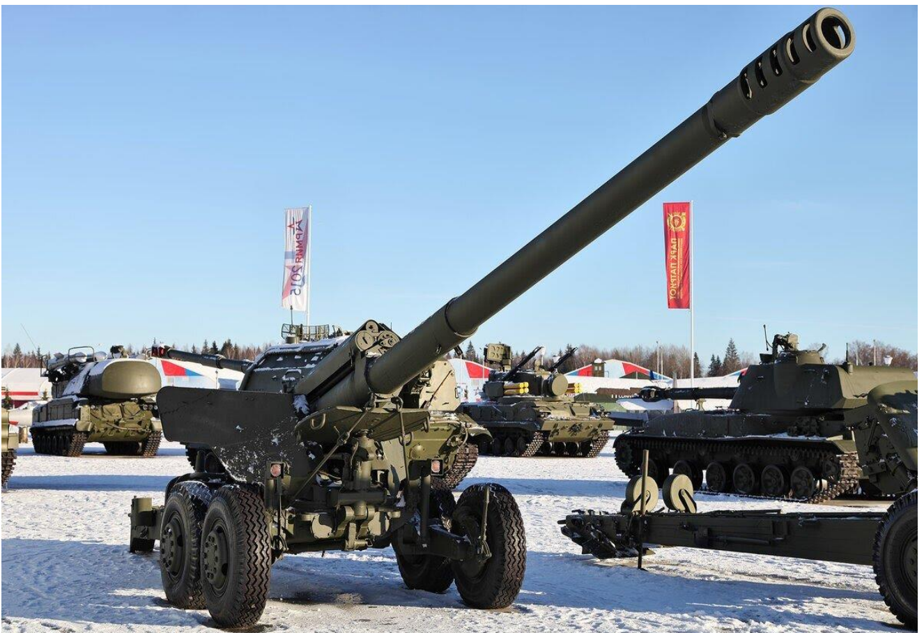
152-мм пушка 2А36 «Гиацинт-Б». Начальная скорость снаряда — 0.945 км/с
